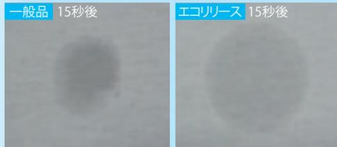
生地片に水を滴下して、重量測定する。
